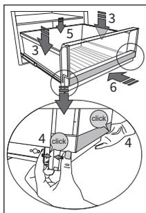
要将抽屉装回滑轨,请将两侧的滑轨完全拉出。将抽屉置于滑轨上(3)。将抽屉的前面压紧在其左右两侧的滑轨,直到听到一声“咔哒”声(4)。在必要时向下按压抽屉的背板(5)。最后,让抽屉完全滑入内部(6)。
